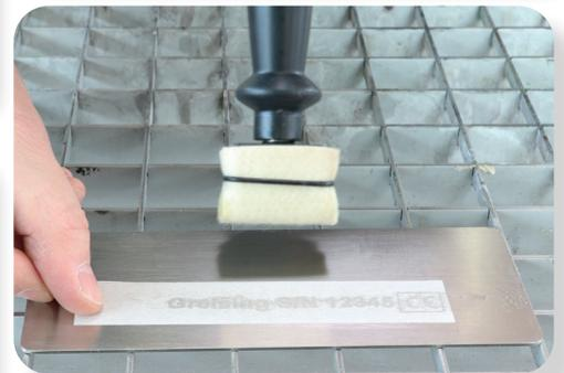
Individuelle Signiervorlagen werden auf Kundenwunsch jederzeit gefertigt. Diese Vorlagen lassen sich bis zu 500-mal wieder verwenden und sind dank der verwendeten Siebdruckschablone gestochen scharf.
